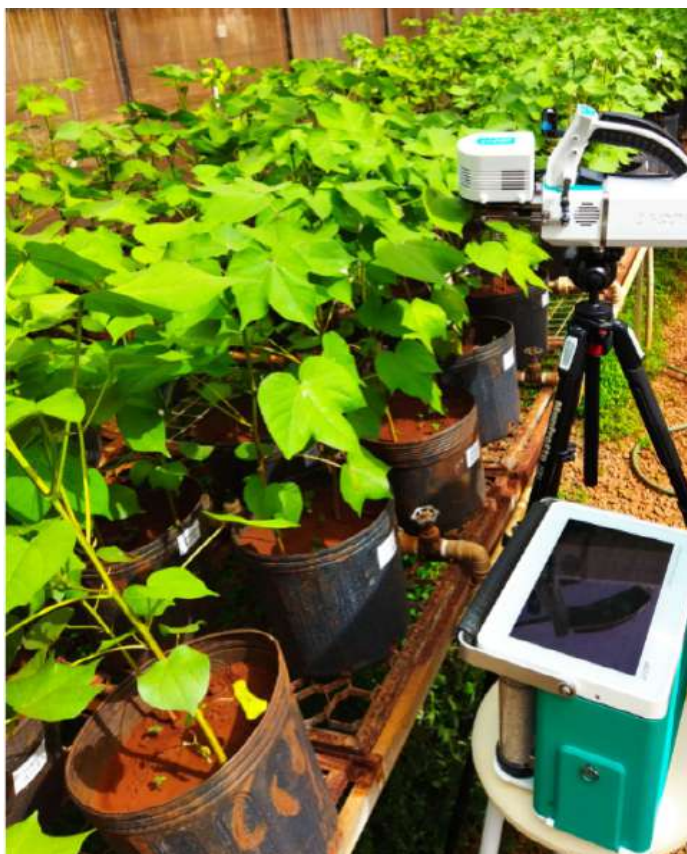
Figura 6. Coleta de dados para índices de trocas gasosas realizada com o analisador de gás no infravermelho (IRGA).
