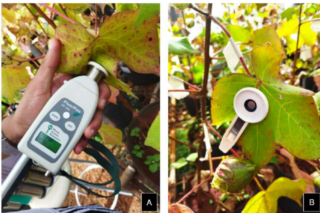
Figura 5. Coleta de dados de fluorescência da clorofila. Fluorômetro executando leitura dos dados (A) e área foliar da coleta de dados sendo adaptada ao escuro para análise (B).
