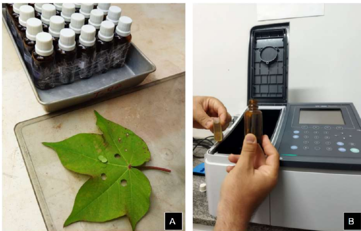
Figura 4. Análise de pigmentos fotossintéticos. Coleta de discos foliares para extração de pigmentos (A) e análise da extração com espectrofotômetro (B).
